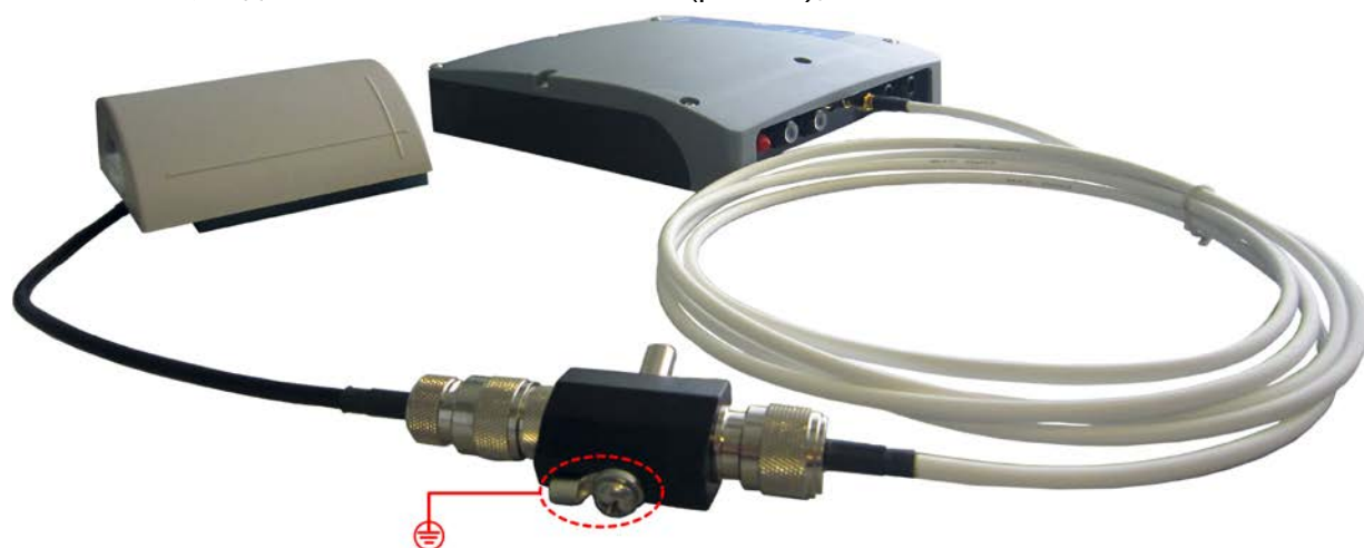
Рисунок 18. Установка грозоразрядника с комплектным кабелем
