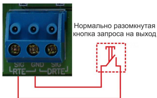
Рисунок 17. Подключение кнопки запроса на выход
