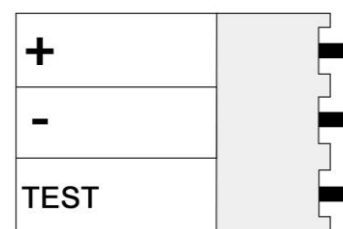
Рисунок 3. Назначение контактов разъема POWER
