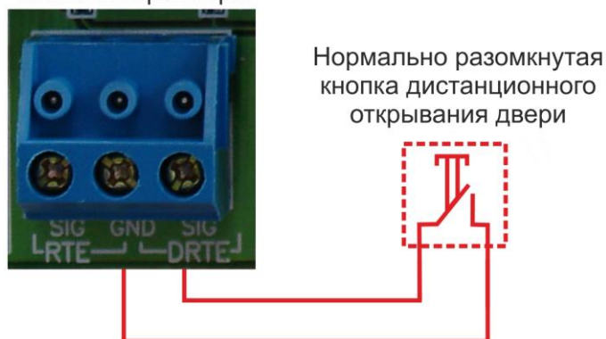
Рисунок 18. Подключение кнопки запроса на выход
