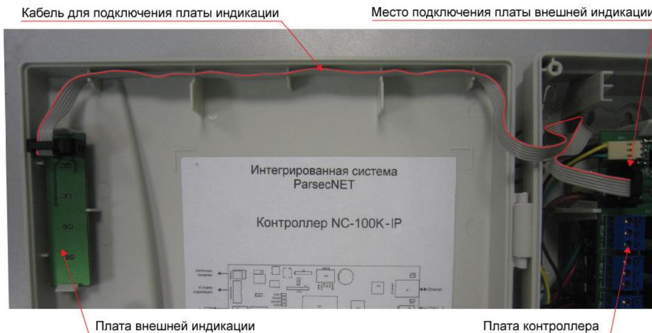
Рисунок 25. Схема подключения платы индикации
