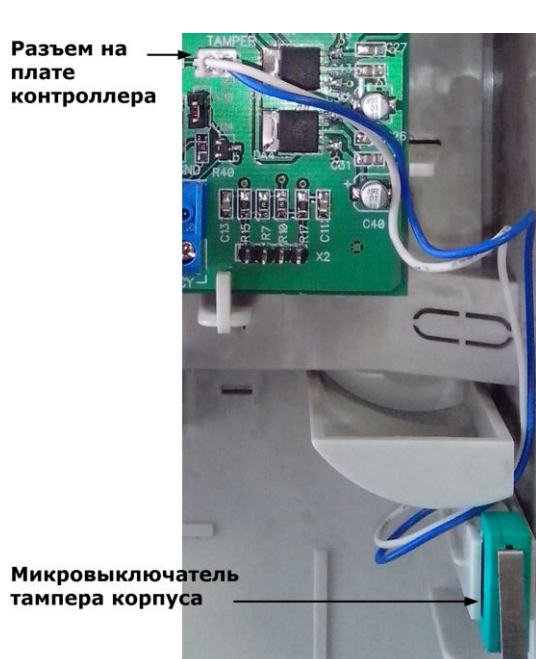
Рисунок 21. Подключение тампера корпуса
