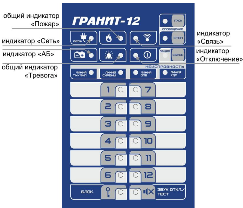
Рис.2 Панель индикации и управления прибора Гранит-12
